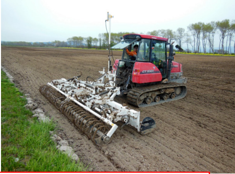
「レベラー作業」レーザー光線付のレベラーで、田面を均一に均す作業。作業機のポールは受光機 2017. 5. 8撮影
