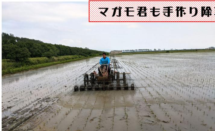
**手作り乗用除草機快調です。2021.6.7撮影** 当地は沈車防止が最大の命題。軽量化を極めた特製自家製機。軽量化した部品の田車などは2町歩程度で消耗。早朝から日没まで除草機掛け、夜は遅くまで鉄の切断、穴あけ、溶接などの消耗部品交換・改良の工作作業を続ける季節です。
